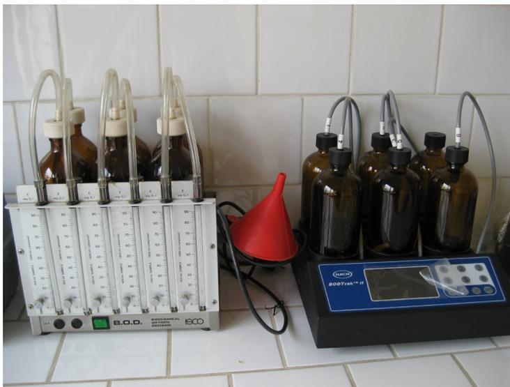
Fig. 2.1 - Determinação laboratorial de  $CBO_5$ .
