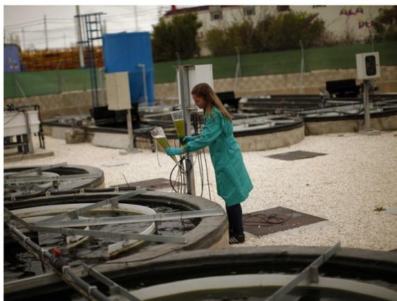
Figura 4.5 - Controlo analítico num reator biológico por lamas ativadas..
