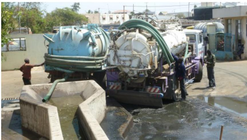
Figura 3.7 – Descarga de camião limpa fossas na obra de entrada de uma ETAR.
