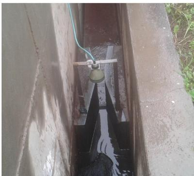
Fig. 2.4 - Medidor de caudal do tipo Parshall.
